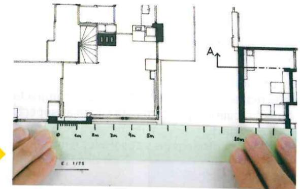
Observa en la fotografía cómo se emplea una escala gráfica para poder medir la planta trazada a escala 1:75.
