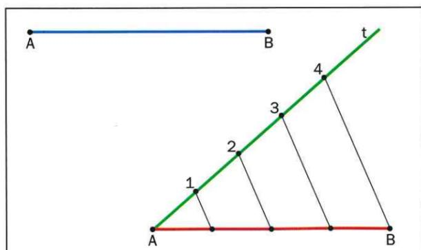
1. Para dividir el segmento  $\overline{AB}$  en cuatro partes iguales, se traza desde A una semirrecta  $t$  en una dirección cualquiera y se marcan cuatro divisiones iguales sobre ella.
