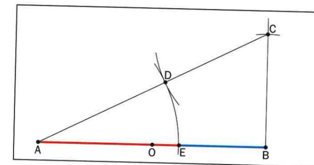
1. Se traza el segmento  $\overline{AB}$  y se halla su punto medio O. Por el extremo B se levanta su perpendicular. Con centro en B y radio  $\overline{OB}$ , se traza un arco que corta a la perpendicular en el punto C, y se une C con A.
